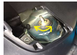
「リアダイヤル位置」 室内サービスホールカバーを取外した所のダンパー上部
