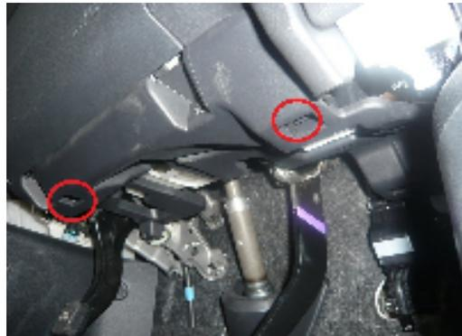
運転席下のパネルを外します。左図の2カ所に8mmボルト、右図の2カ所にツメで固定されています。
