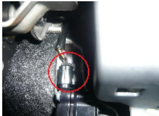
パネルには左図のようにハーネスがついているので3つのクリップを外します。
